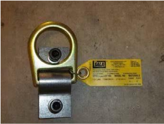
图6 双螺钉 D 型环锚定盘 使用 ½"-13 TPI UNC 1-1/2" 长 8 级内六角圆柱头螺钉和防松垫圈（扭矩最大 40 英尺-磅）固定
